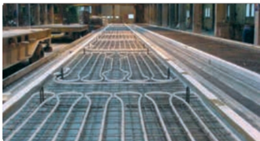
Moduly Geocore BATISO zabudované do prefabrikované betonové desky
