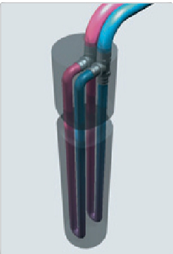
Instalace paralelních trubkových smyček
